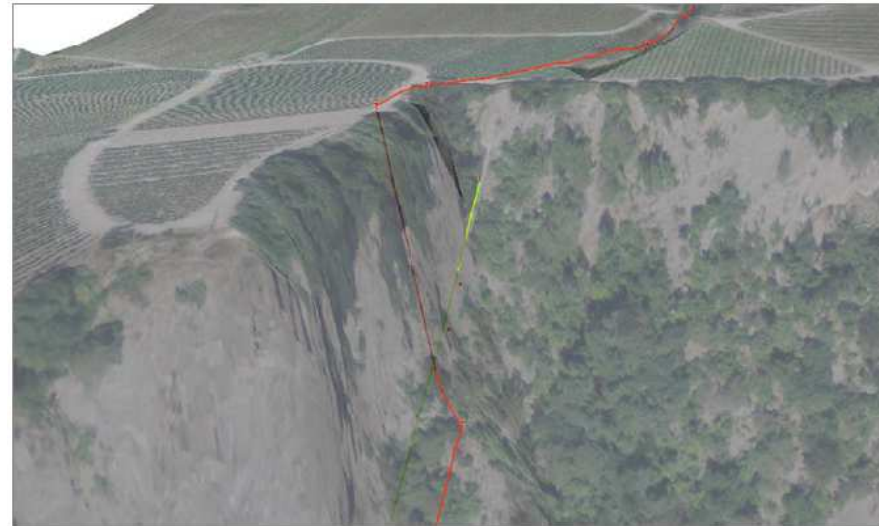
Abbildung 10: Druckleitungsführung im Bereich Dude (3D-Ansicht)
